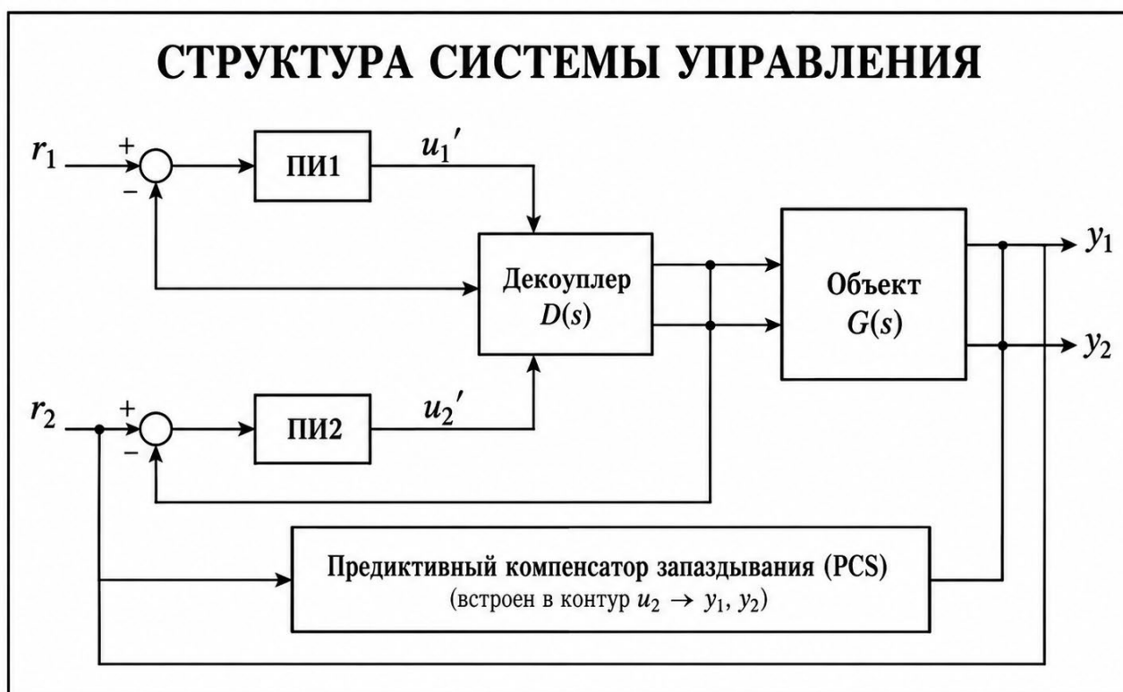
Рисунок 1 – Структурная схема САУ гранулятором с децентрализованным регулированием, динамическим декоуплером и предиктивной компенсацией запаздывания (источник: разработано авторами)
