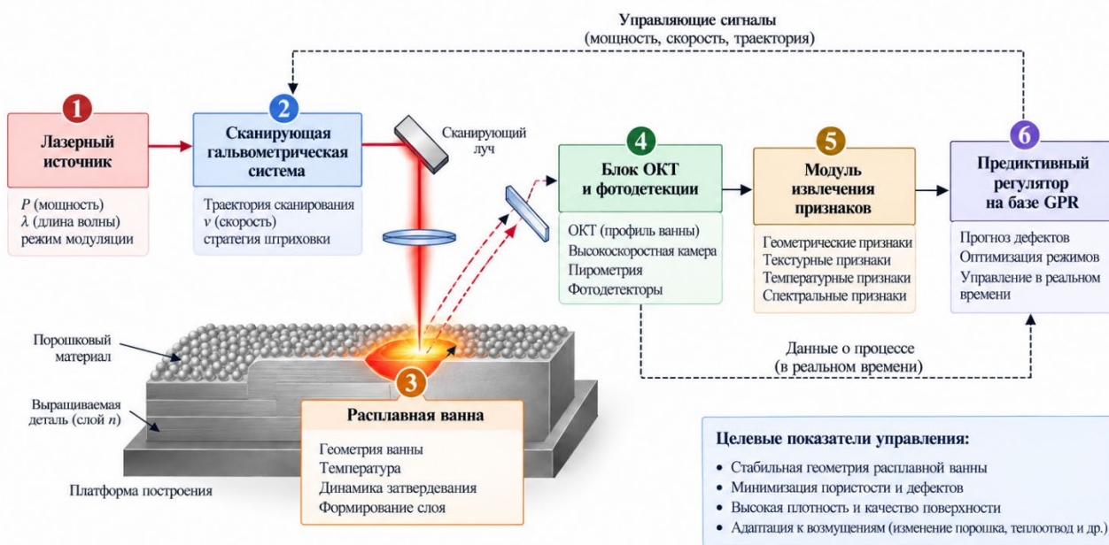
Рисунок 1 - Структурная схема системы оптического мониторинга и предиктивного управления (источник: разработано автором)
